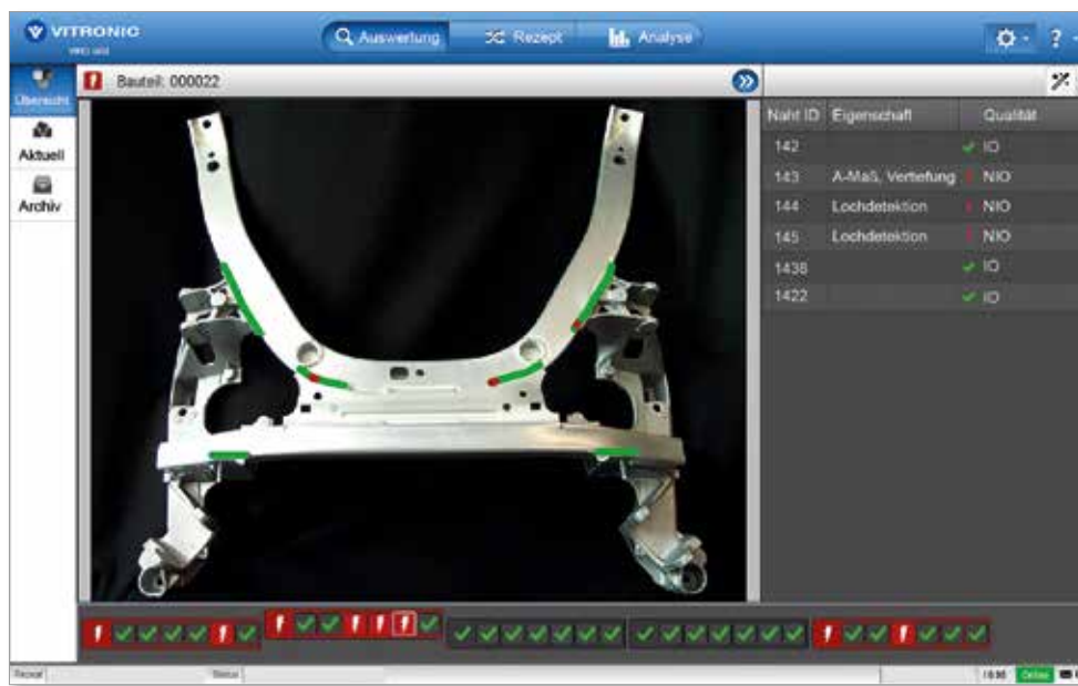
Werkeransicht: klare Fehlerdarstellung im Live-Betrieb
