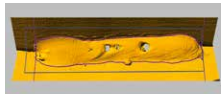
Kehlnaht mit Poren: 3D Visualisierung für Werker
