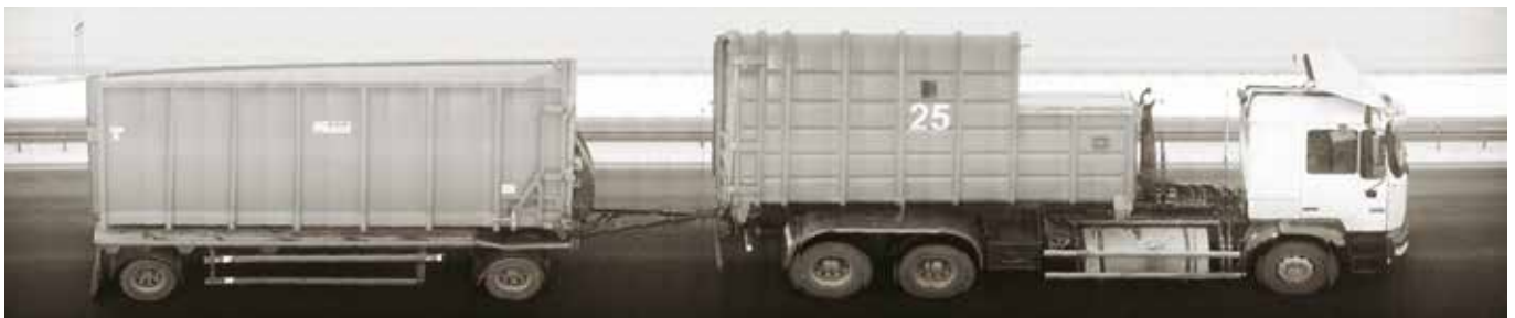
Hochaufgelöste Bilder zur Klassifizierung von Fahrzeuggröße, -typ, Anzahl der Achsen und Anhängern
